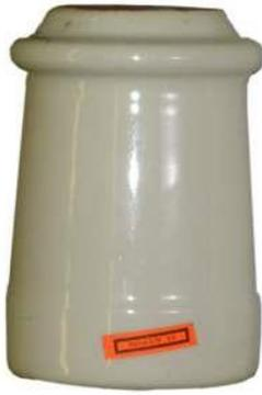
Опорные изоляторы ИОР-10-3,75 УХЛ2 применяются для изоляции и крепления токоведущих частей в электрических аппаратах и распределительных устройствах номинальным напряжением сети до 10 кВ частотой до 60 Гц. Изоляторы ИОР-10-3,75 УХЛ2 изготовлены в соответствии с требованиями ТУ 3493-003-53962489-2004.
