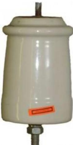
Изолятор ИО-10 применяется для изоляции и механического крепления токоведущих частей в электрических аппаратах и для монтажа токоведущих шин распределительных устройств электростанций и подстанций. Изо
