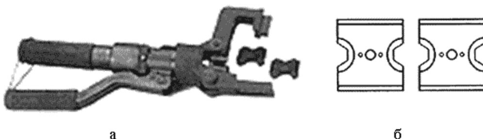
Рис. 2.6. Гидравлический пресс НТ 50 (а) с матрицей Е 173 (б)
