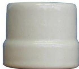
Изоляторы РО-1 предназначены для изоляции и крепления токоведущих частей в электрических аппаратах и распределительных устройствах номинальным напряжением сети до 1000 В частотой до 60 Гц для работы в районах, расположенных на высоте до 1000 м над уровнем моря.
