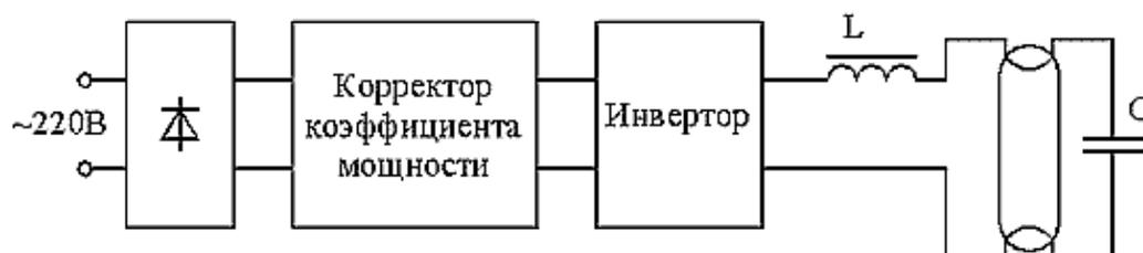
Рис. 6.5. Силовая блок-схема ЭПРА
