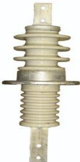
Проходной керамический Изолятор ИПУ-10 применяется для изоляции и проведения токоведущих частей закрытых распределительных устройств, для соединения с открытыми распределительными устройствами или с линиями электропередач на переменное напряжение до 10 кВ. Может использоваться как для работы в атмосфере, так и для закрытых токопроводов.
