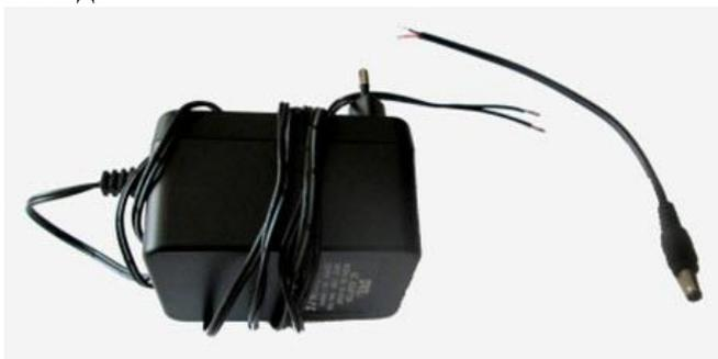
7. Взять кабель разъема и "прощупываем" его тестером в режиме прозвонки:
