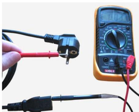
Среднее отверстие это - "земля". Как и в предыдущих примерах, при одной из комбинаций должны услышать звуковой сигнал.
