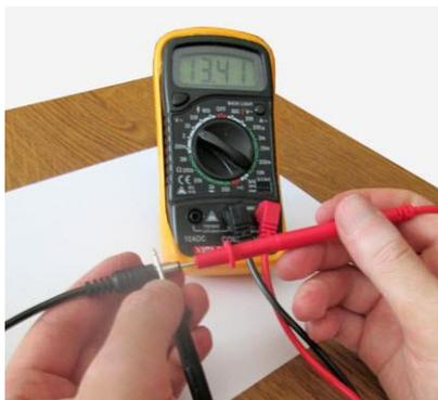
Примечание: иногда разъем слишком узкий и погрузить в него наконечник не получится. В таком случае используют распрямленную скрепку которую вставляют внутрь, а к ней уже прикладывают щуп.
