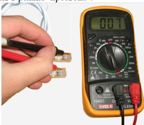
**Примечание:** щупы должны быть достаточно тонкими, чтобы добраться до медных пластинок в коннекторе RJ-45.
