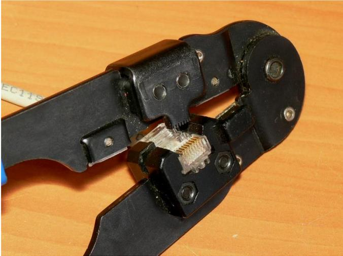
Рис. 9. Коннектор RJ-45 в обжимном инструменте
