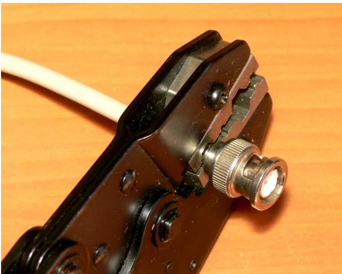
Рис. 5. Коннектор BNC в обжимном инструменте
