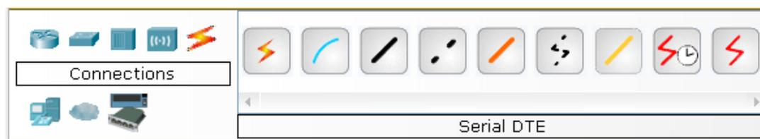
Рис. 5 Поддерживаемые в Packet Tracer типы кабелей.
