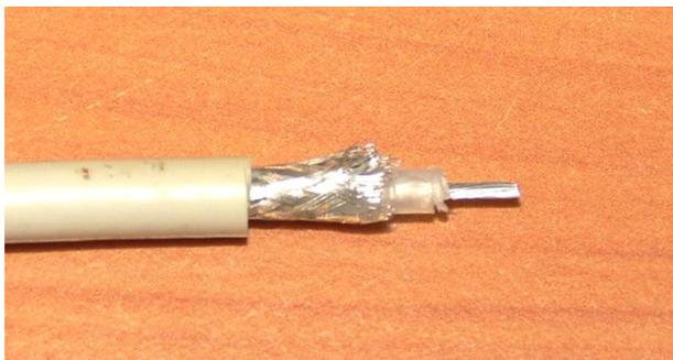
Рис. .2. Коаксиальный кабель RG-58 после зачистки
