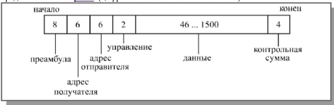
**Рис 2.** Структура пакета сети Ethernet
