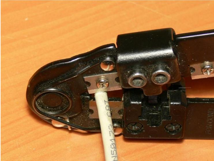
Рис..6. Обрезка внешней изоляции на кабеле «витая пара»
