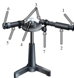
Рисунок 9.2– Устройство спектрографа двухтрубного
