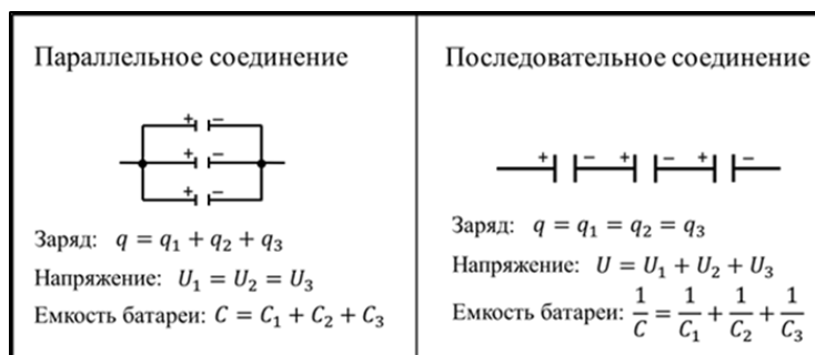
Рисунок 3.3– Формулы расчета соединений конденсаторов
