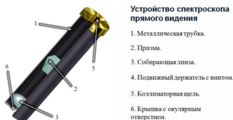
Рисунок 9.1– Устройство спектроскопа прямого зрения
