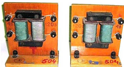
Рисунок 7.2– Устройство лабораторного трансформатора
