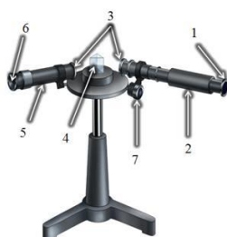
Рисунок 9.2– Устройство спектроскопа двухтрубного
