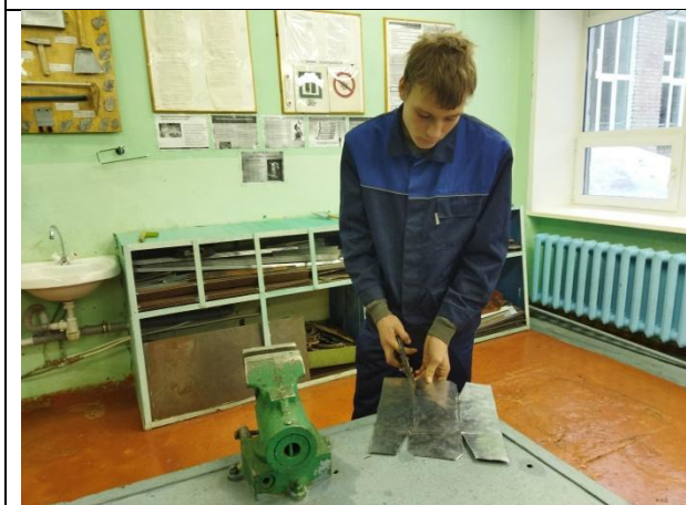
3. Вырезка заготовки по контуру
