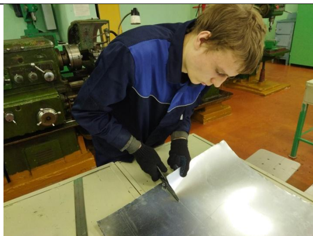
2. Раскрой материала на заготовки
