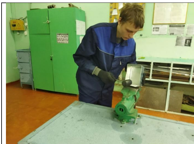
5. Сгибание всех стенок ящика до требуемой формы
