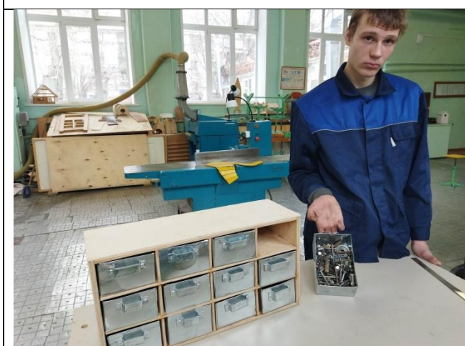
7. Соединение ручки к ящику клепками
