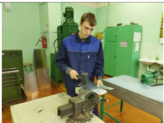
4. Сгибание стенок ящика под углом 90^{\circ}
