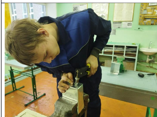
7. Соединение ручки к ящику клепками
