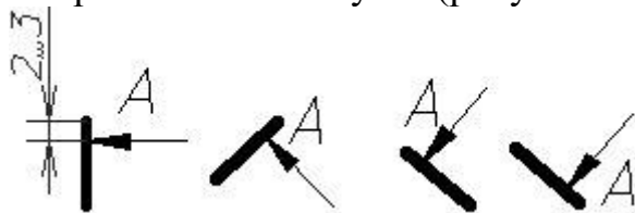
Рисунок 4.10 - Примеры обозначения разреза
