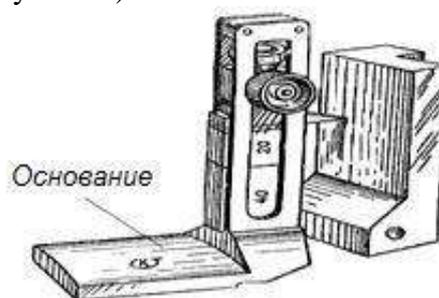
Рисунок 10 – Разметка горизонтальных линий
