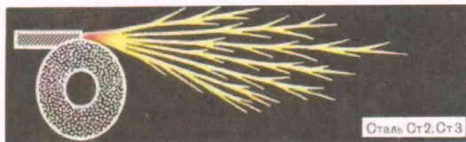
рис 4.Определение стали по цвету искр
