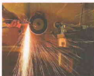
Рис. 1. Определение стали по искре. Рис 2. а сталь Ст3, рис 2. б Ст3
