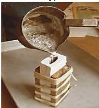
Рис. 4 Заливка формы оловом
