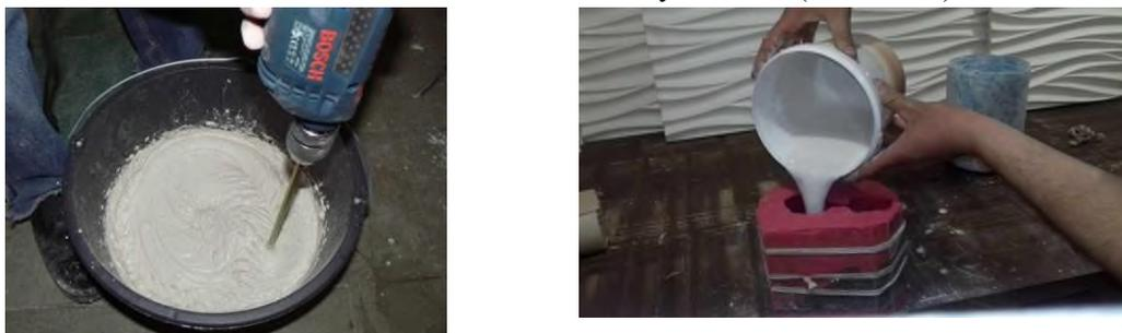
Рис.2 Подготовка гипса и заливка в форму
